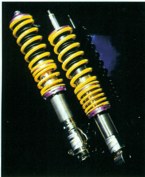
Speziell angefertigte und gekürzte Federbeine mit darauf abgestimmten Federn sorgen für guten Bodenkontakt und genügend Restfederweg.
