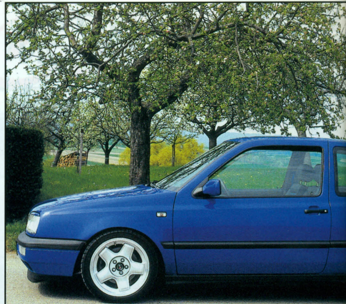
Revolution-Felgen 7,5 und 9x16-Zoll passen perfekt unter die aufgeweiteten Radhäuser.
