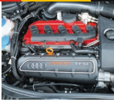
Größerer Turbo, Auspuff und Elektronik entlocken dem Fünfzylinder 555 PS
