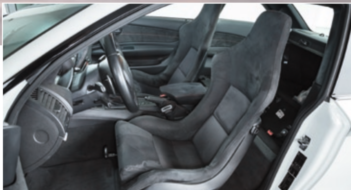
Auch innen wurde ordentlich versportlicht. Vollschalensitze aus dem BMW M3 CSL (E46), Lenkrad mit Schaltwippen und Tacho bis 360 km/h
