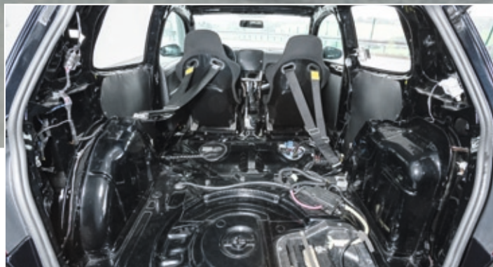
Die Rothe-Diät bringt gegenüber dem Serienauto einen Gewichtsvorteil von über 130 Kilogramm. Fahrer und Beifahrer logieren in Recaro-Vollschalen
