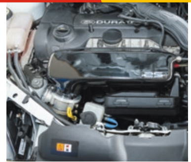
Größerer Lader und komplett neue Auspuffanlage für 512 statt 305 PS
